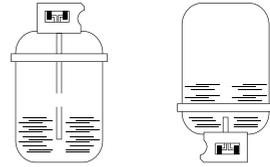
Манометр LP показывает давление внутри внешнего бака.
